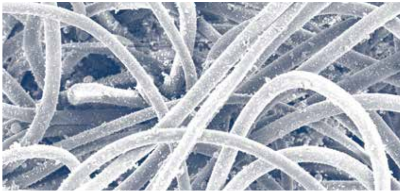
Manga de Poliéster Perforada Lado de Aire Limpio (300x)
