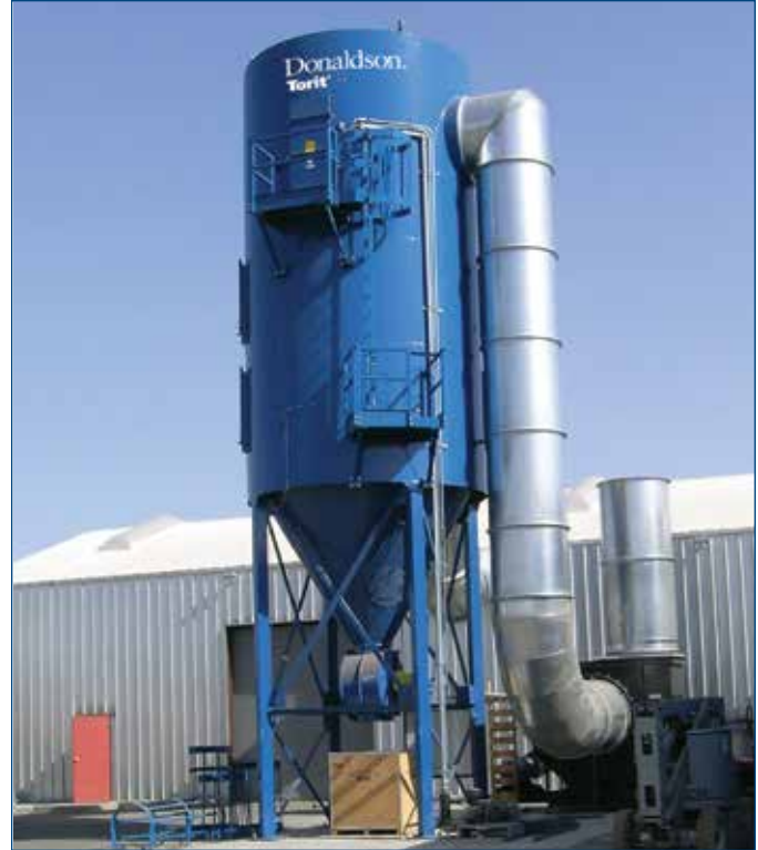
Las bolsas Dura Life en este colector de polvos Donaldson Torit RF proporciona vida más larga y menores emisiones en esta planta de procesamiento de frijol de soya del Medio Oeste
